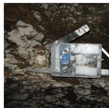
а) б) Рисунок 4. Фотопост с таймером на микроконтроллере: а) структурная схема; б) устройство установлено в пещере К-4.
